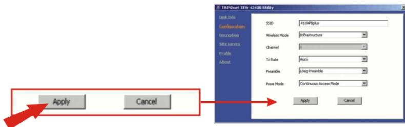
5. Si vous souhaitez activer le cryptage, cliquez sur le lien Encryption. Cliquez sur la boîte située à côté de Data Encryption (Encryptage des données), entrez la clé WEP correspondant à vos paramètres d'encryptage sans fil et cliquez ensuite sur **Apply (Appliquer)**.
